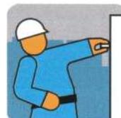
Limpe o furo e ajuste o componente a ser fixado a fim de garantir que o mesmo esteja alinhado com o furo.
